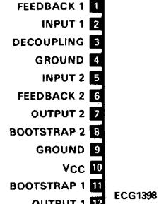
**ECG1399** 12-Pin SIP-HS See Fig. L92
