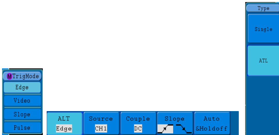
Abb.34 Menü für alternierenden Trigger (ALT) (Triggertyp: Edge)
