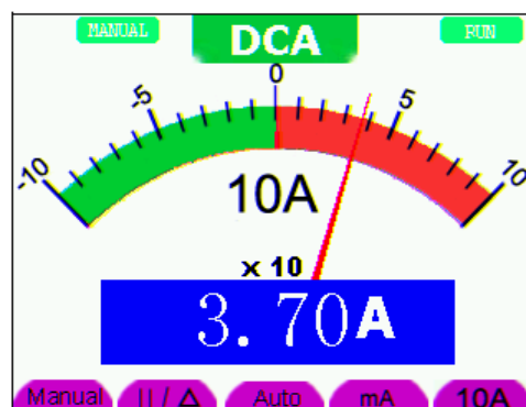
Abbildung 28: Gleichstrommessung <10 A (DCA)
