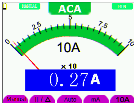
Abbildung 30: Wechselstrommessung <10 A (ACA)
