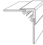
Gehäusebleche (d=1,5mm) in Profileinzüge eingeschoben.
