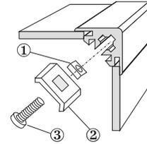
Klemmbefestigung für Bleche von d= 2 bis 5 mm
