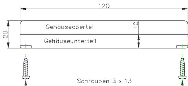
Gehäuseunterteil und Oberteil schwarz mit innenliegenden Befestigungsmöglichkeiten für Platinen im Gehäuseoberteil sowie im Gehäuseunterteil.
