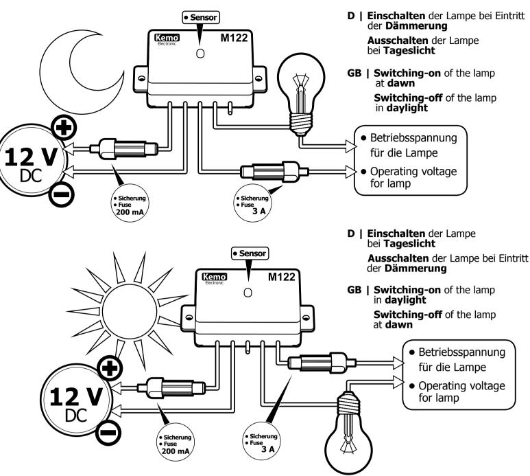
**D | Achtung!** Wie aus den Zeichnungen ersichtlich, kommt aus dem Ausgang des Moduls keine Spannung zum direkten Anschluss einer Lampe. Im Modul ist ein Relaiskontakt enthalten, der die Lampe schaltet. Sie müssen also die Betriebsspannung für die Lampe extra zuführen (gemäß Zeichnung). Es kann die gleiche Spannungsquelle sein, mit der auch das Modul betrieben wird! Oder auch eine andere Spannungsquelle, falls die Lampe eine andere Betriebsspannung hat als 12 V.
